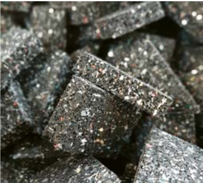
Isopads aus 95 % Altreifengranulat
